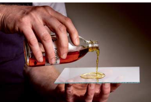
Handarbeit: Die Glas- oder Metallplatten werden mit einer zähflüssigen Kollodiumlösung begossen.
